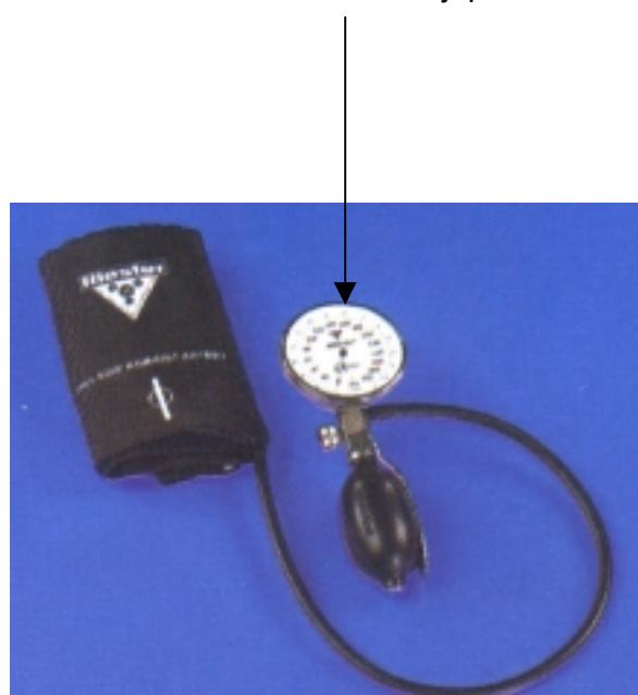
Slika 1: Fotografija tlakomjera tip Precisa N s prikazom mesta za smještaj ovjerne naljepnice
